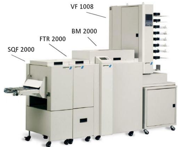
Modèle présenté avec pliage/agrafage, massicot de chasse et module de finition "dos carré".
